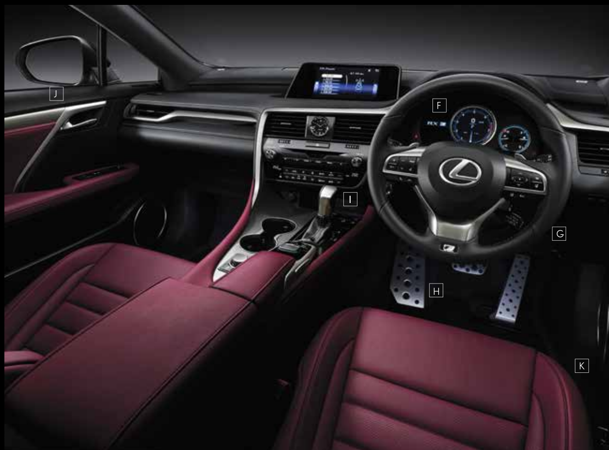
F_Meters & Multi-information Display / G_Steering Wheel / H_Aluminum Pedals / I_Shift Lever Knob / J_Trim (Aluminum) / K_Scuff Plates F_มาตรวัดและจอ Multi-information / G_พวงมาลัย / H_แป้นเหยียบอลูมิเนียม / I_หัวเกียร์ / J_ขอบแผงประตู (อลูมิเนียม) / K_คัลลิเฟอร์กันโคลน
